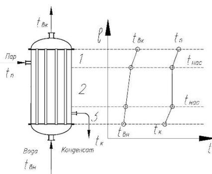
6 На рисунке изображен противоточный барометрический конденсатор. В порядке перечисления укажите штуцера:
