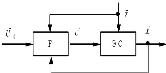
31. Структурная схема разомкнутого управления ЭС с учетом внешних воздействий
