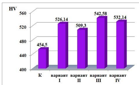
Рисунок 1 - Влияние материала катода имплантера на нанотвердость
