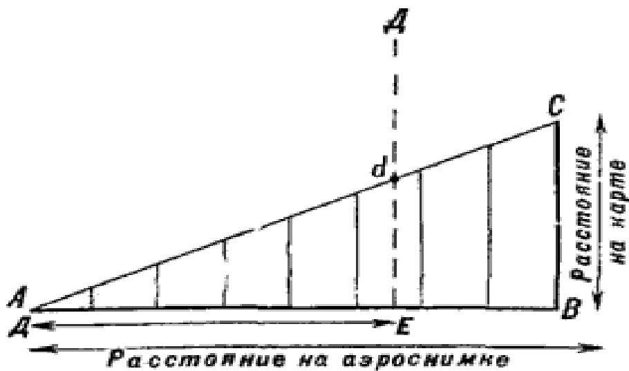
Если масштаб соседних аэроснимков значительно различается, то расстояние по линейке следует отсчитывать по частям: от начальной точки до середины перекрытия и от середины перекрытия до конечной точки, потом каждый отрезок умножается на величину масштаба соответствующего аэрофотоснимка.
