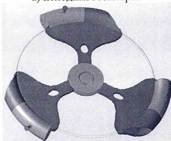
в) результат топологической оптимизации
