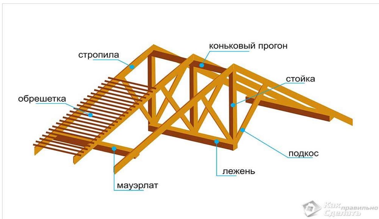
Рисунок 4.4 - Элементы стропильной системы
