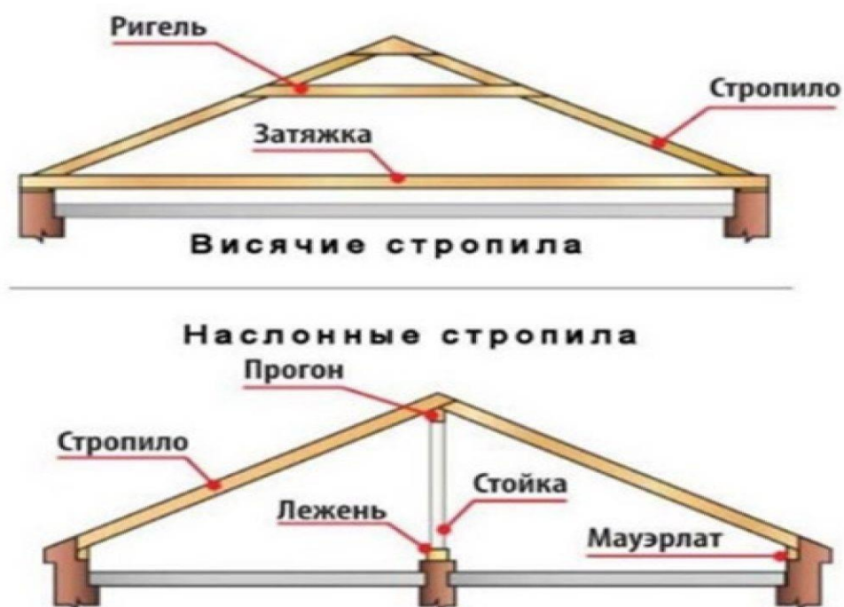
Рис. 4.4 – Виды конструкции стропильной системы
