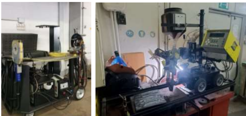
Рисунок 36 - Оборудование орбитальной сварки и сварочный трактор Лаборатории сварочных процессов
